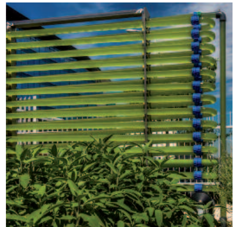
Le PBR vertical light, exemple de tubes cylindres de bioréaction.
